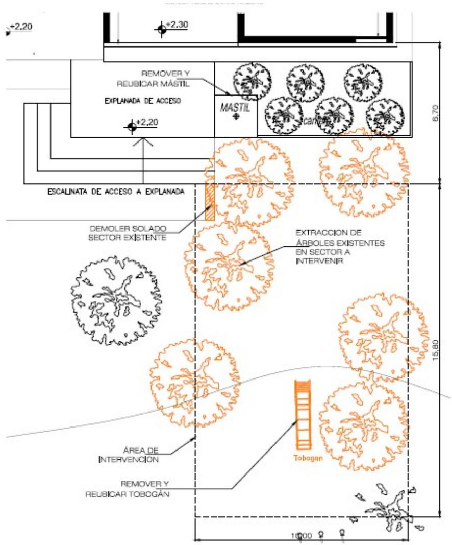
PLANO DE DEMOLICIÓN - esc.: 1:125
